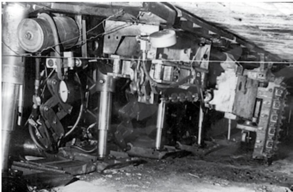
Агрегат безлюдной выемки угля
