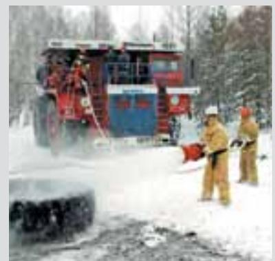
БелАЗ-7513, карьерный самосвал, используемый для орошения технологических дорог в летний период, дополнительно оборудован специальным насосом, рукавами и лафетом, которые предоставил пожарно-спасательный отряд Междуреченска.
